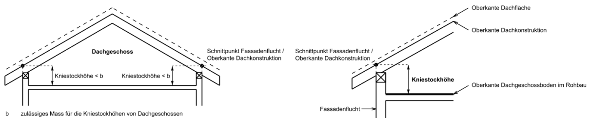
Abbildung 17: Figur 6.3 Dachgeschoss und 5.3 Kniestock, IVHB
